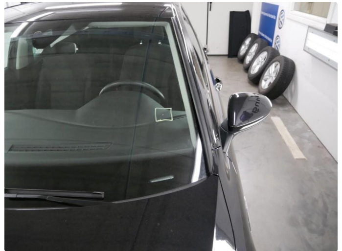
1.1 Steinsprut med sprekk
