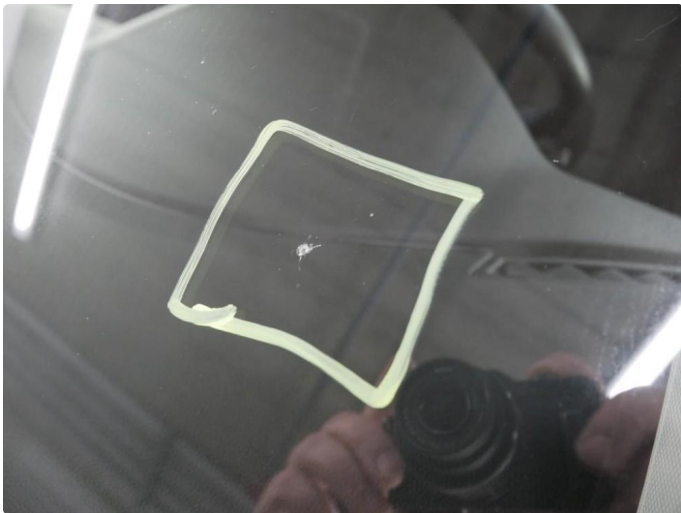
1.1 Steinsprut med sprekk
