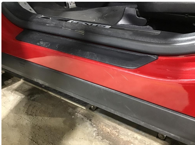
1.1 Noen riper og steinsprang i lakken
