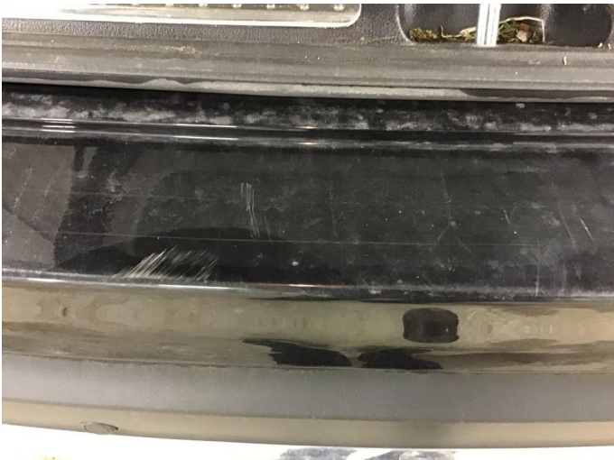
1.4 Noe slitasje i innlasting til varerom
