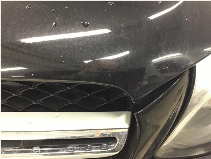
1.2 Noe steinsprut i panser
