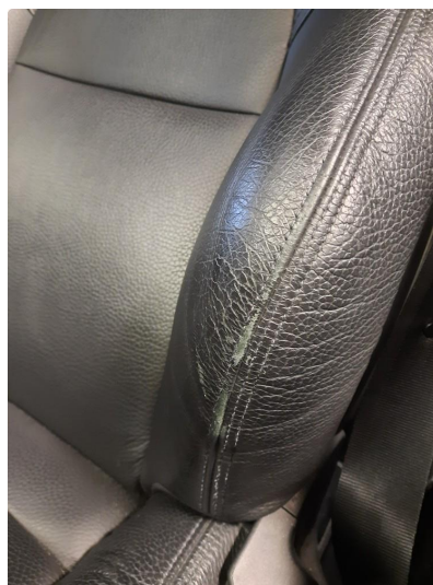
4.1 Skade på setetrekk
