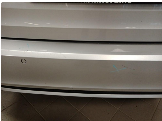
1.3 Støtfanger bak lakkeres før levering
