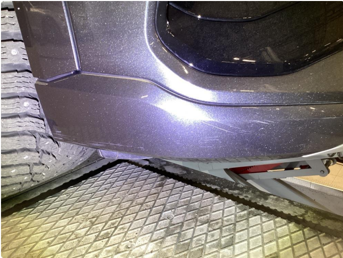
1.2 Noen riper på støtfanger
