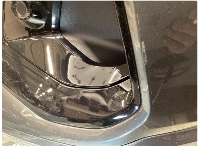
1.2 Noen riper på støtfanger
