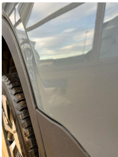
1.1 Noen svake riper og en liten bulk på dør høyre bak
