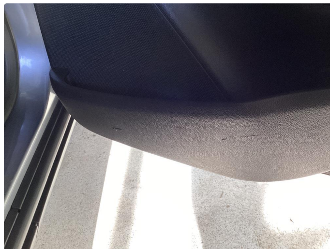
2.2 Riper på høyre bak dørtrekk
