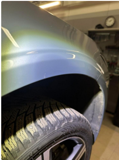
1.7 Noe riper høyre forskjerm
