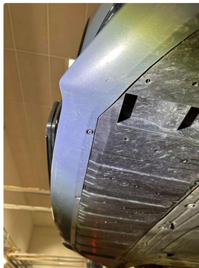
1.10 Noe skrubbskader underkant støtfanger fremme
