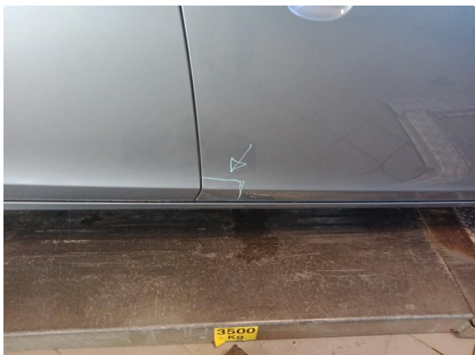
1.1 Dør høyre foran lakkert grunnet bulk
