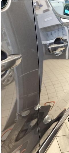
1.1 Små riper høyre fordør og skyvdør
