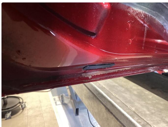
1.1 Lakk har flasket av flere steder i under kant av alle dører hvor det er lakkert over karosseri masse.
