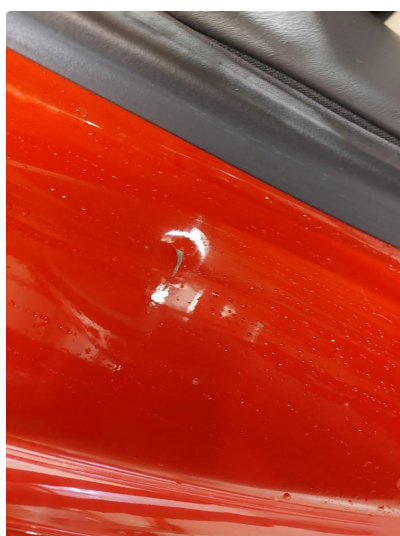
3.8 Bulk(er) med lakkskade
