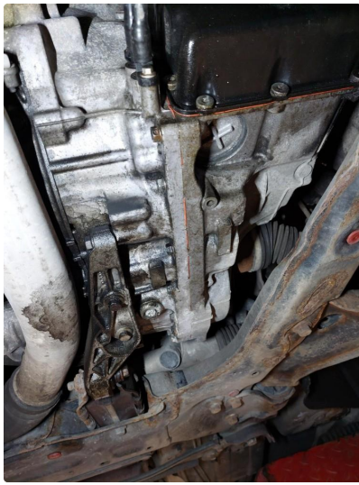
4.1 Oljelekkasje fra motor
