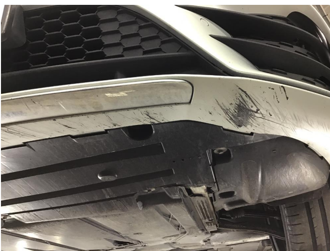
1.4 Skrubbskader i underkant av støtfanger
