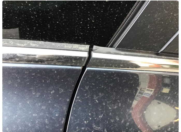
1.1 Litt skadede lister, bakdører.
