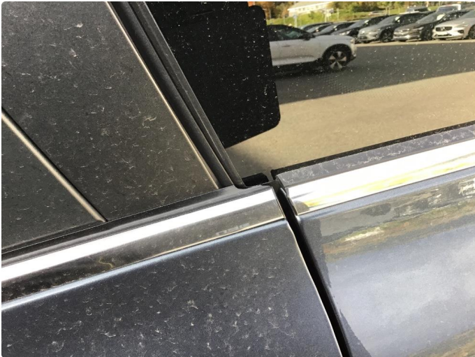
1.1 Litt skadede lister, bakdører.
