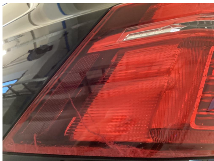
2.3 Krakelering og sprukket venstre ytre baklykt - Garanti
