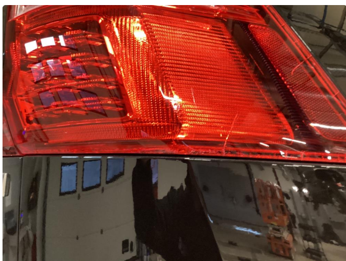
2.2 Krakelering og sprekker i høyre ytre baklykt - Garanti
