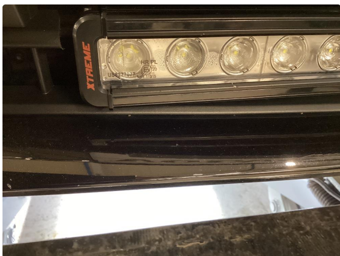
2.6 Fukt i led bar , sprekk i glass.
