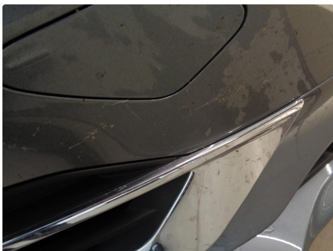
1.1 Forurensing lakk ytre påvirkning
