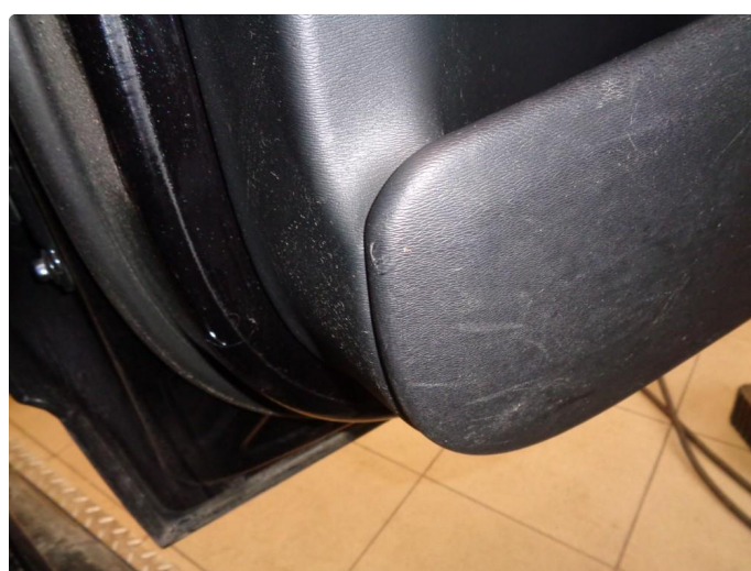
2.1 Skadet/merker etter utstyr
