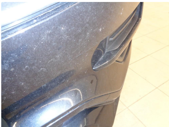
1.1 Forurensing lakk ytre påvirkning
