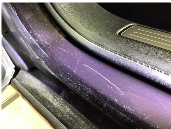
1.5 Ripper i innsteg/dørterskel alle 4 dører
