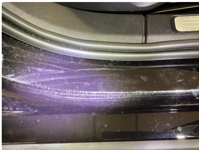
1.5 Riper i innsteg/dørterskel alle 4 dører
