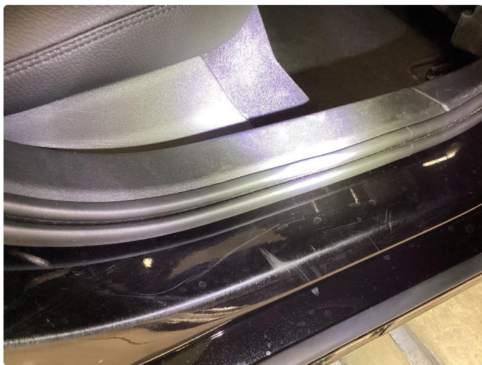
1.5 Riper i innsteg/dørterskel alle 4 dører
