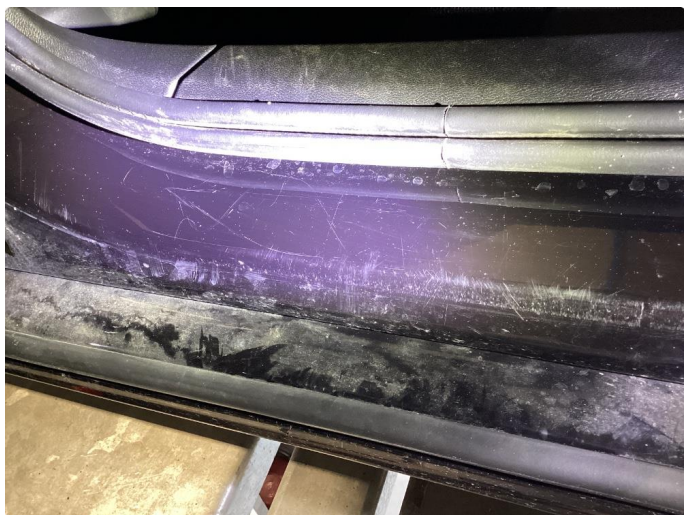
1.5 Riper i innsteg/dørterskel alle 4 dører
