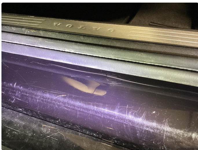
1.5 Riper i innsteg/dørterskel alle 4 dører
