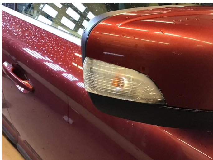
3.3 Krakelering i plast
