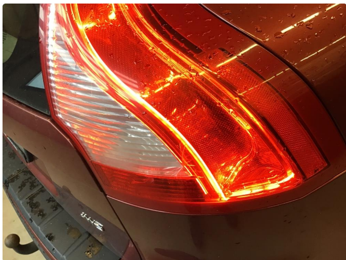
3.1 Krakelering i plast
