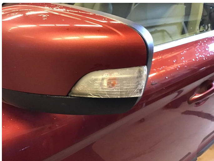
3.3 Krakelering i plast
