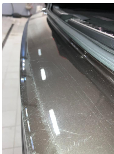
1.4 Noe bruksmerker/riper innsteg bagasjerom.
