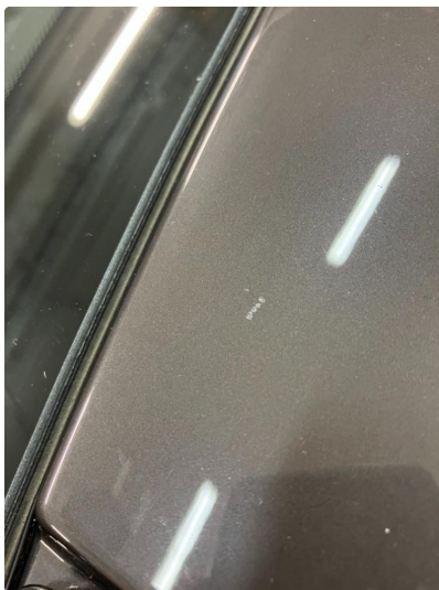
1.5 Liten steinsprut tak
