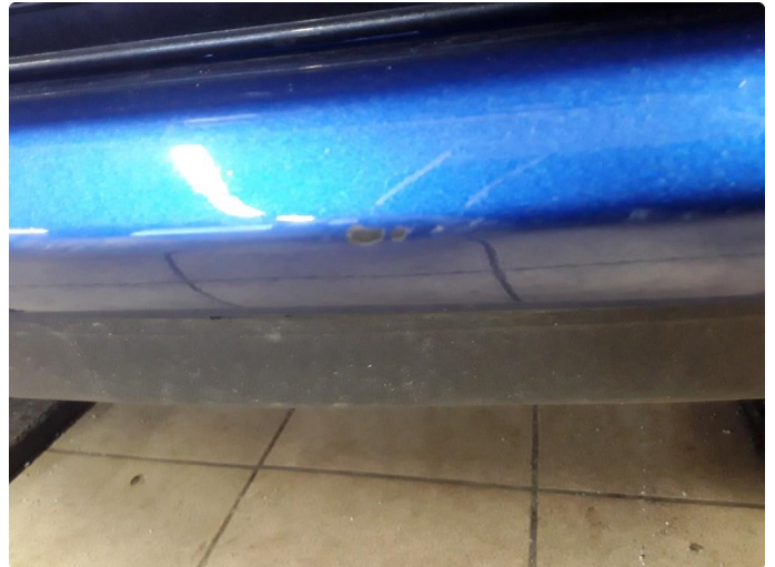
1.2 Skrubbskader underkant Foran høyre side og midt på
