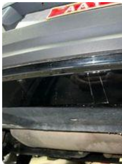
1.5 Noe skrubbe skader bak fanger underkant.
