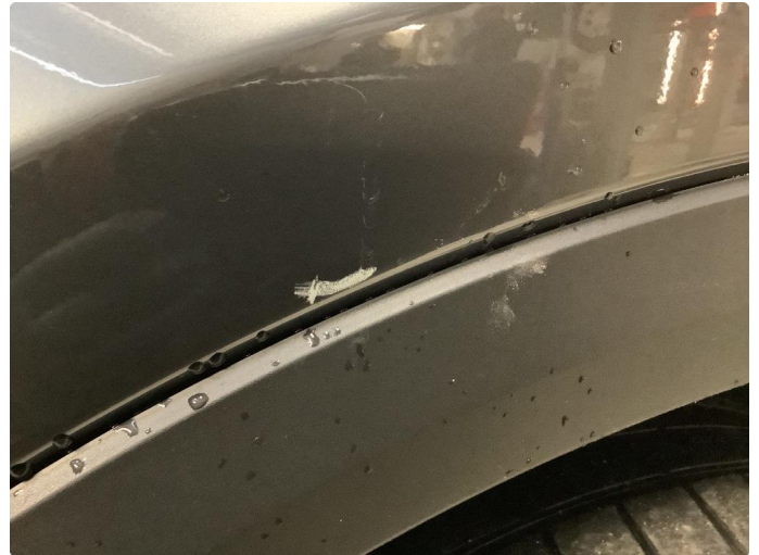
1.2 Rep av skade. flekket i lakk og polert
