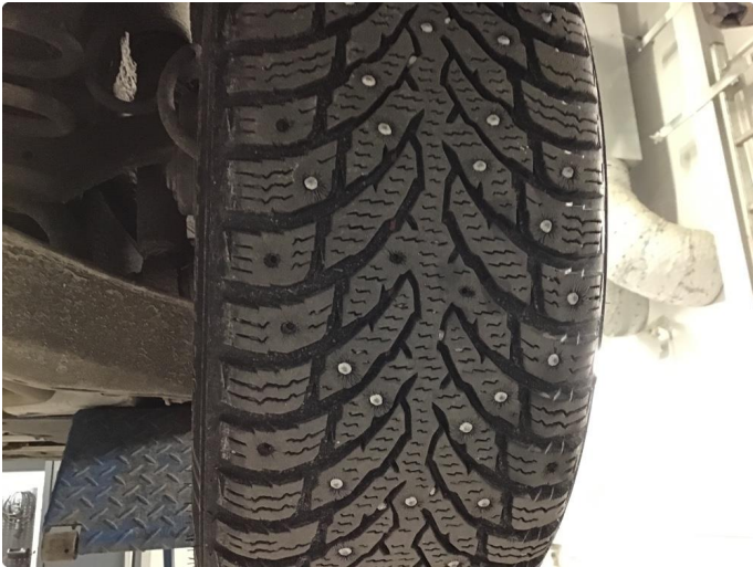
1.2 Mangler en del pigger på vinterdekk bake.
