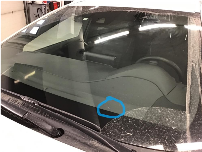
1.3 Skiftet frontrute på grunn av steinsprang.
