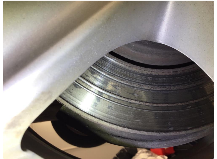
2.1 Skiftet bremseskiver foran og bak.
