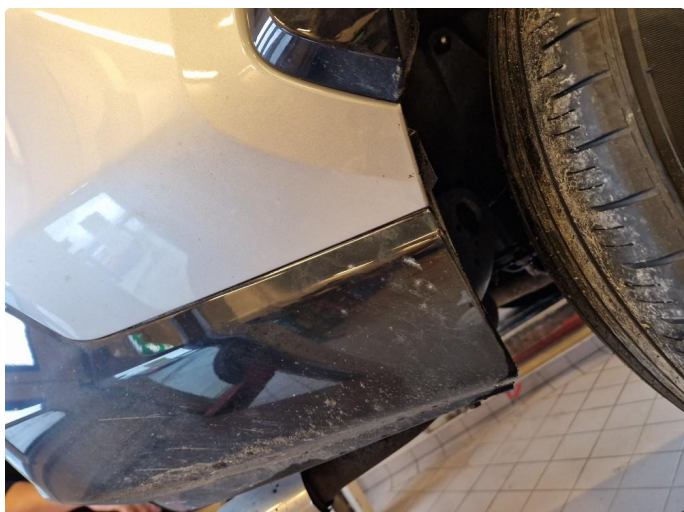
1.1 Forurensing lakk ytre påvirkning
