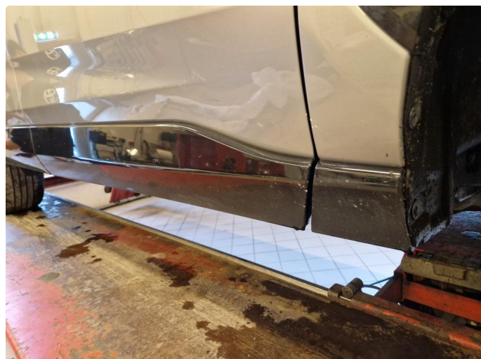
1.1 Forurensing lakk ytre påvirkning
