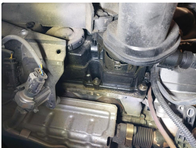
2.1 Oljelekkasje fra motor
