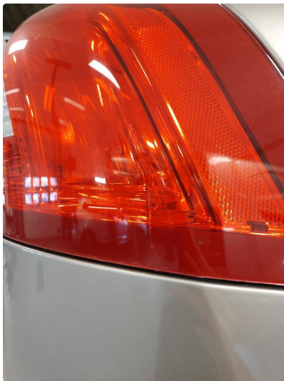
2.1 Defekt / sprukket glass
