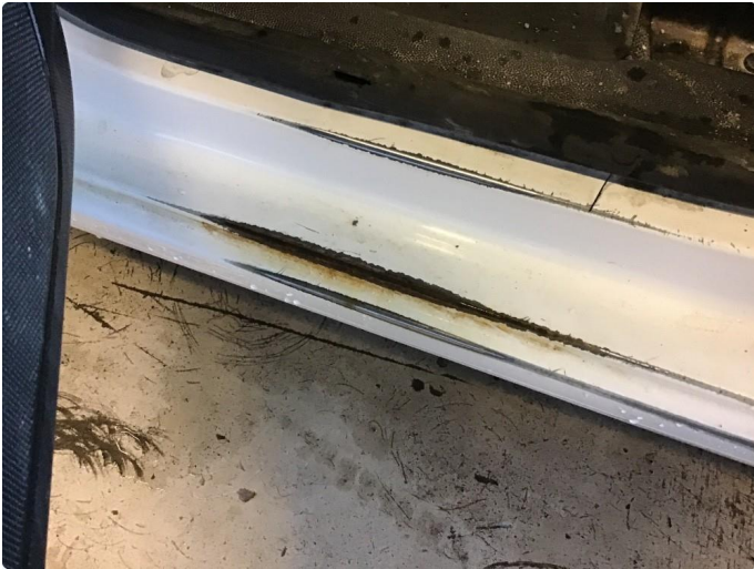
1.4 Slitt innsteg, folie monteres for hindring av korrosjon
