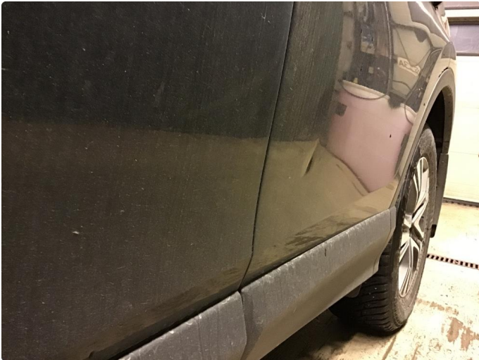
1.2 Bulk, fikses ved første mulighet, smart repair
