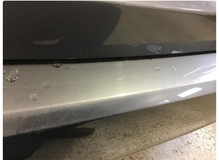
1.3 Noe slitasje i innlasting til varerom
