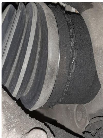
2.1 Drivaxelmansjett defekt. byttes
