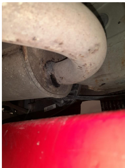
3.1 Ok reparert. eksoslekkasje
