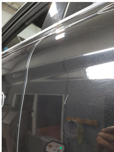
1.1 Ripe ned til grunning
