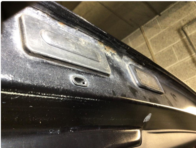
1.1 Utbedret lakkkrust på innside bakluke, nederst
