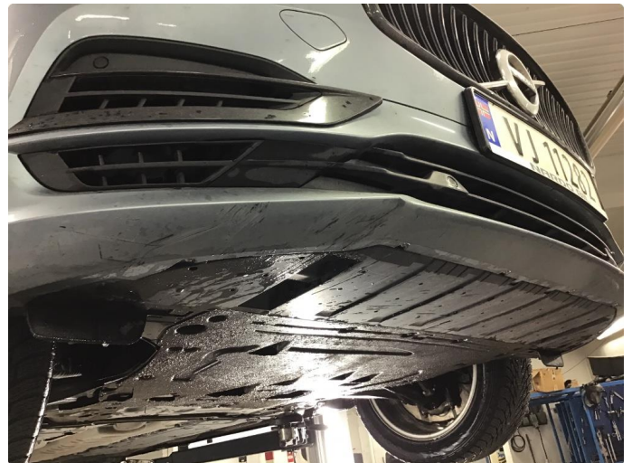
1.2 Mindre skrubbermerker i underkant av frontfanger
