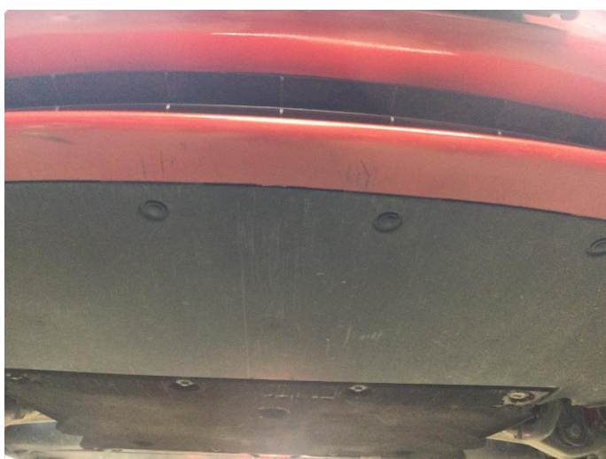
1.5 Noe riper på undersiden
