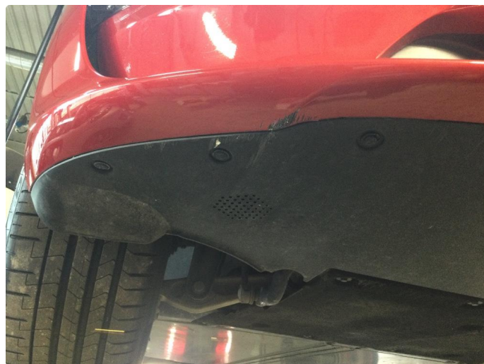
1.5 Noe riper på undersiden
