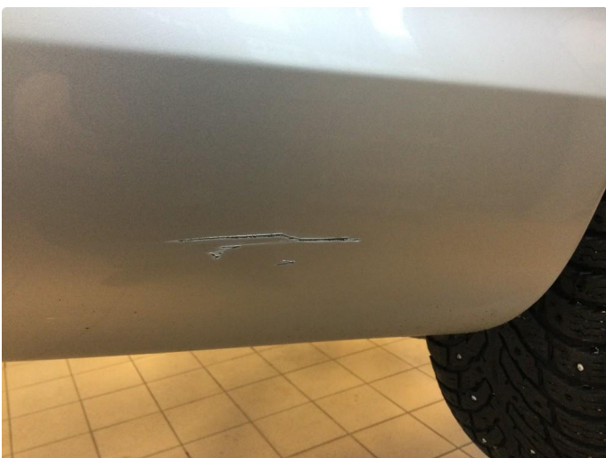
1.7 Ripe(r) ned til grunning
