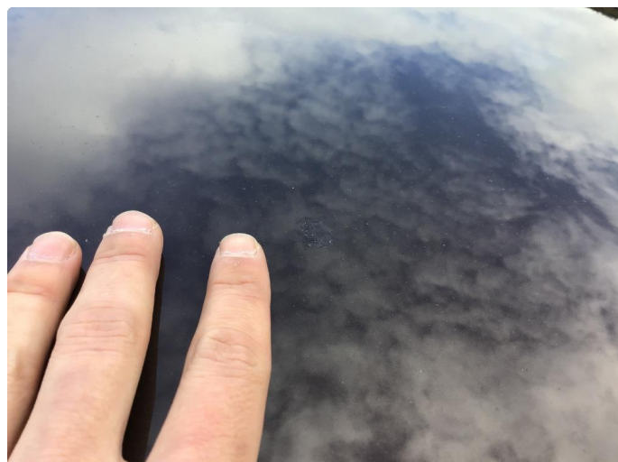
1.1 Noe steinsprut med rust
