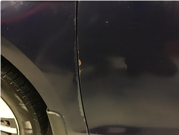
1.1 Lakk flasset, forsøkt flekkklakket
