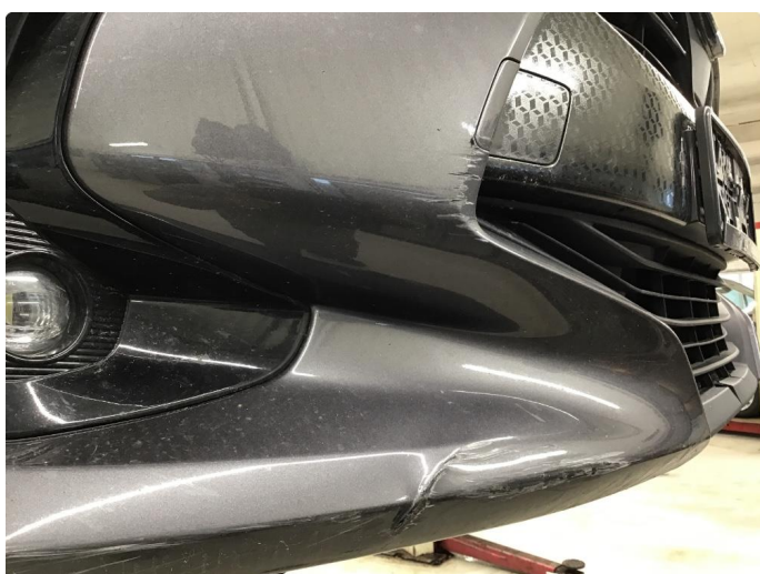
1.1 Ripe(r) ned til grunning
