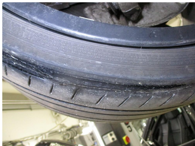
1.2 Skjev slitasje på sommerdekk
