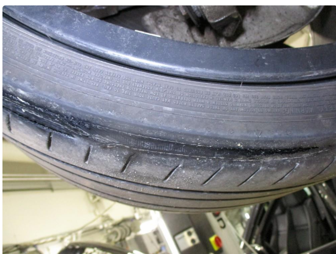
1.2 Skjev slitasje på sommerdekk
