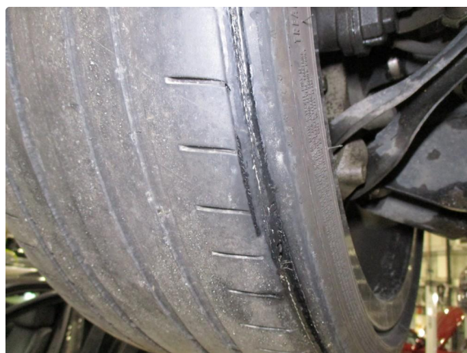
1.2 Skjev slitasje på sommerdekk
