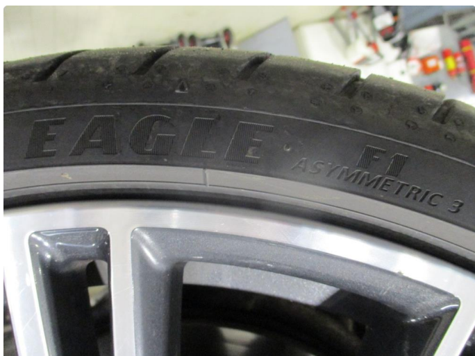
1.2 Skjev slitasje på sommerdekk
