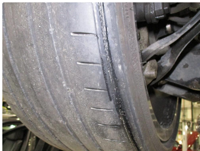
1.2 Skjev slitasje på sommerdekk
