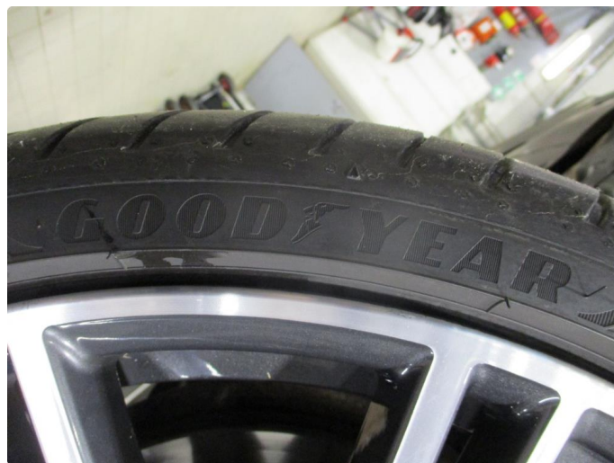
1.2 Skjev slitasje på sommerdekk
