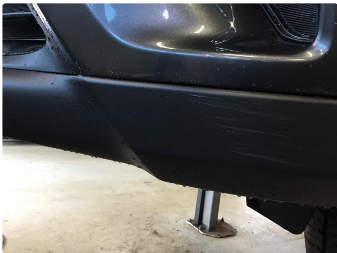
1.3 Ripe(r) ned til grunning
