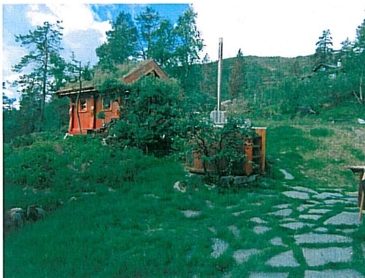
**Standard:** Eiendommen er vurdert i den stand den var på befaringdagen. Hytte er oppført i år 2001 etter gjeldende regelverk og forskrift. Under befaring ble det påpekt feil og mangler som har betydning for eiendommen: Manglende lufting i møne. Svak utføring av takrenner, lekkasje i rennesystem. Sig i tak. Sig i laftekasse. Kondensutslag i stue. Sig i kjøkken. Det er tatt hensyn til disse svakheter i vurderingen. Se takst.
