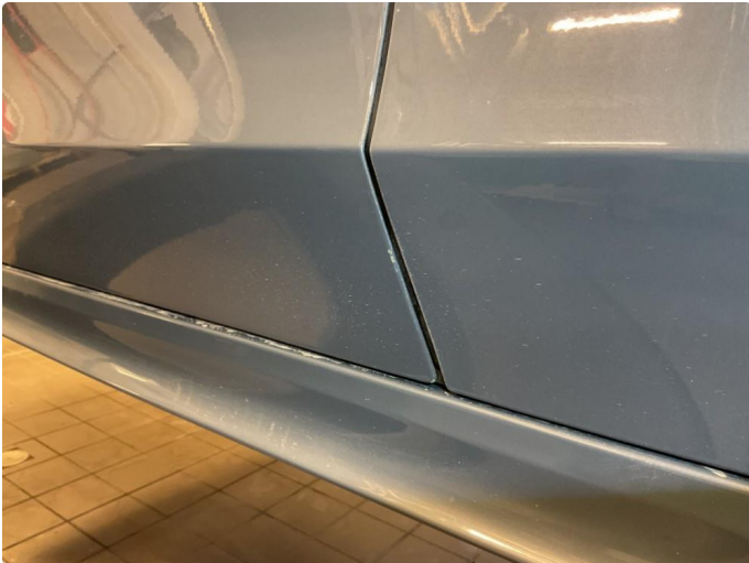
1.1 Lite lakksår i bakkant av førerdør
