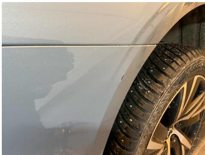
1.6 Lite lakksår høyre side bakfanger
