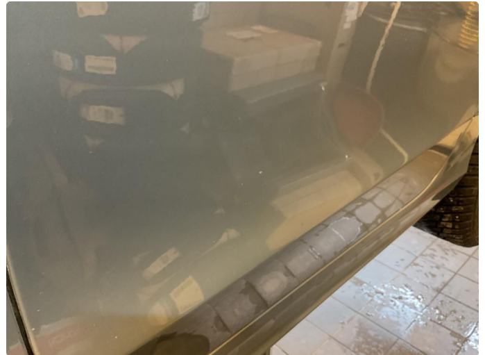
1.2 Noen steinsprang på v/bakdør
