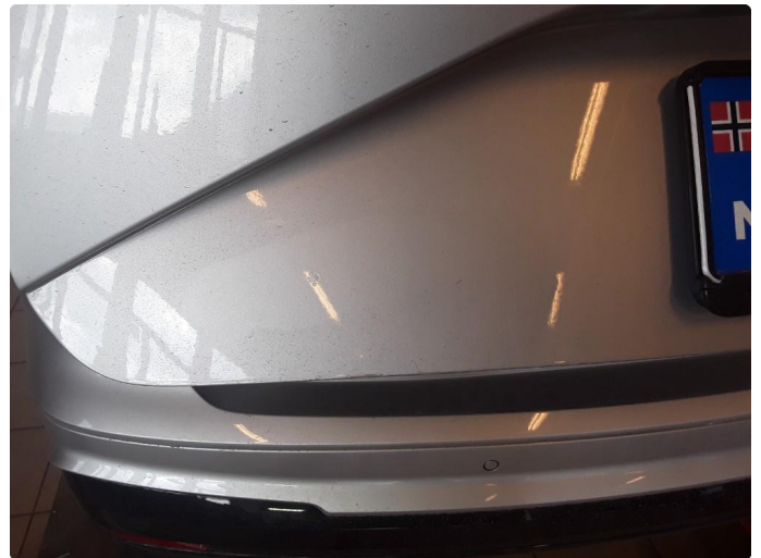
1.3 Liten steinsprut med korrosjon.
