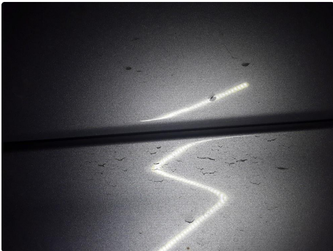
1.2 Liten steinsprut med korrosjon.
