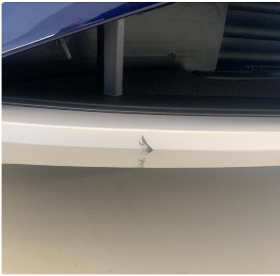
1.6 Noe riper høyre side nedre del og midtre del foran. Lite sår i grill.
