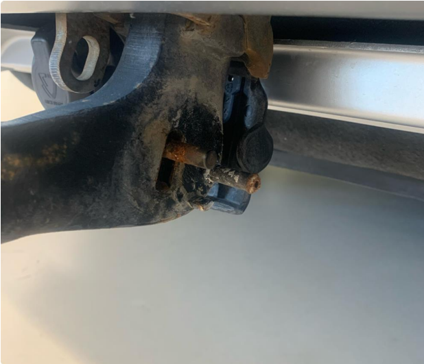
1.2 Fastmontert hengerfeste pga defekt låsefunksjon.
