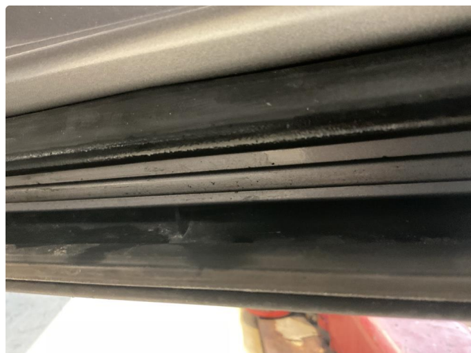
2.1 Rust i fals
