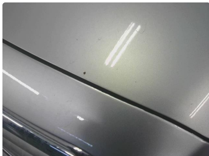
2.1 Noe steinsprut med rust
