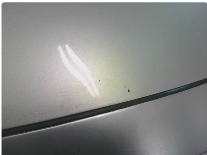
2.1 Noe steinsprut med rust
