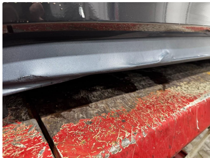
1.3 Liten skade på plast
